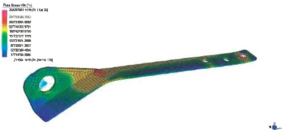
Il massimo sforzo equivalente di Von Mises è pari a 350 MPa < 505 MPa. Il gancio è pertanto in grado di resistere alla forza statica di 10 kN, accumulando deformazioni irreversibili.
