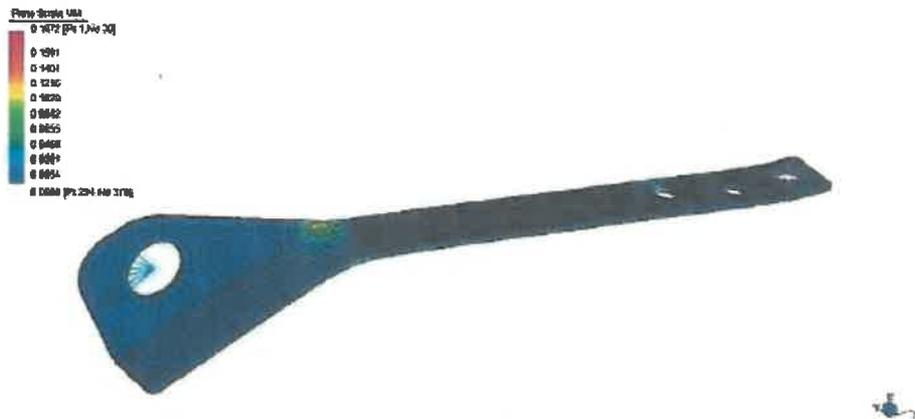
Le massime deformazioni equivalenti sono dell'ordine del 19% (0.19 < 0.4) e si localizzano in prossimità dello spigolo di piegatura.
